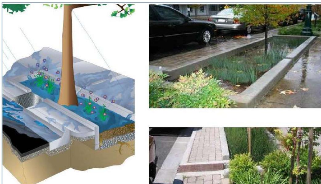
Figure 28 : exemple d'arbre de pluie et fosse pluviale, permettant un relargage progressif des eaux vers le réseau
