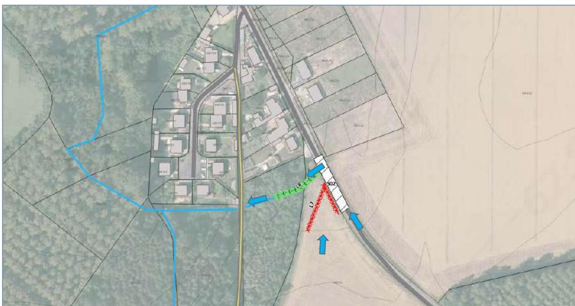
Figure 19 : localisation des aménagements L7, L8 et S02, et principe de déviation des ruissellements
