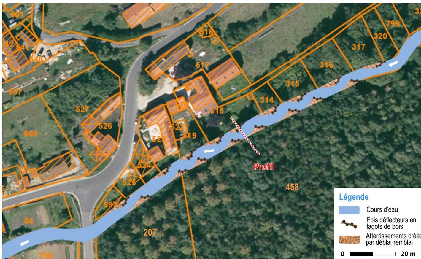
Vue en plan des travaux de diversification des écoulements sur le Clignon à Monthiers
