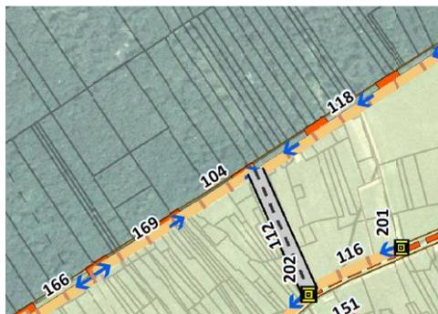
Une prise de côte a été faite au droit de la tête de pont existante. Avec la pose d'un ouvrage de type moine similaire à ceux des bassins, il est possible de faire un stockage/restitution sur 1,5 m de hauteur au droit de la tête de pont sans provoquer de débordement sur le chemin.
