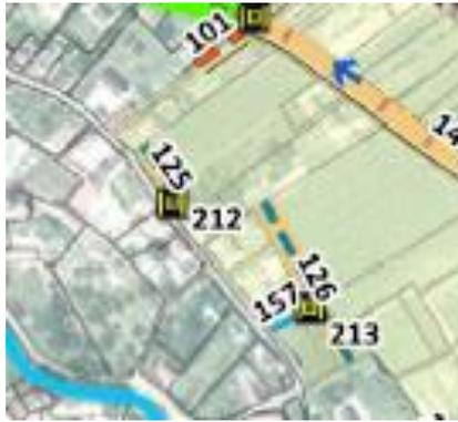
L'ouvrage 125 actuellement enherbé sera reprofilé en V avec la réalisation d'un dépierrure et rejet au réseau pluvial existant.
