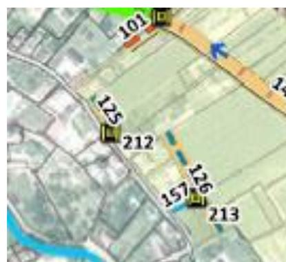
L'ouvrage 125 actuellement enherbé sera reprofilé en V avec la réalisation d'un dépierré et rejet au réseau pluvial existant.
