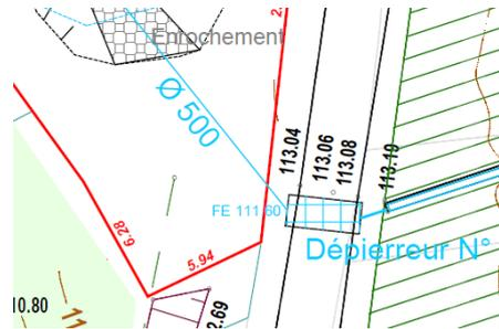
Une cunette engazonnée sera réalisée au droit de cette canalisation pour permettre un ruissellement des eaux vers le bassin en cas de colmatage de la grille par des végétaux divers. **Remplacée par une cunette en béton suite aux orages du 15 et 25/08.**
