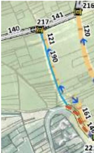
La jonction entre les ouvrages 190 (canalisation de diam 500mm) et le fossé à redents 140 est techniquement compliqué. Voir la possibilité de supprimer la canalisation et de la remplacer par un caniveau de type 90\*30\*30 le long du talus existant.
