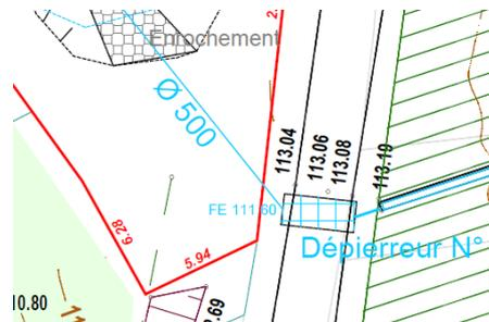
Une cunette engazonnée sera réalisée au droit de cette canalisation pour permettre un ruissellement des eaux vers le bassin en cas de colmatage de la grille par des végétaux divers.
