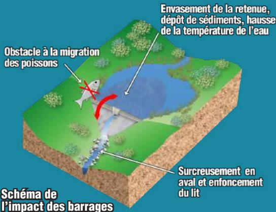
**Schéma de l'impact des barrages**
