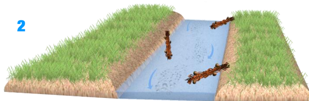
2 Pose d'épis déflecteurs de manière alternée pour diversification des écoulements et décolmatage du chenal central
