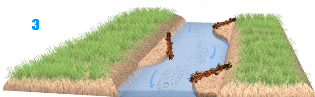
3 Création d'atterrissements en aval immédiat des épis déflecteurs avec réduction de la section d'écoulement en période d'étiage
