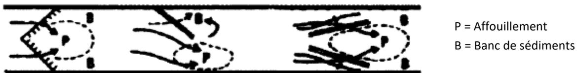
Figure 2 : Affouillement produit par des seuils, épis et vannes (Hey, 1996)
