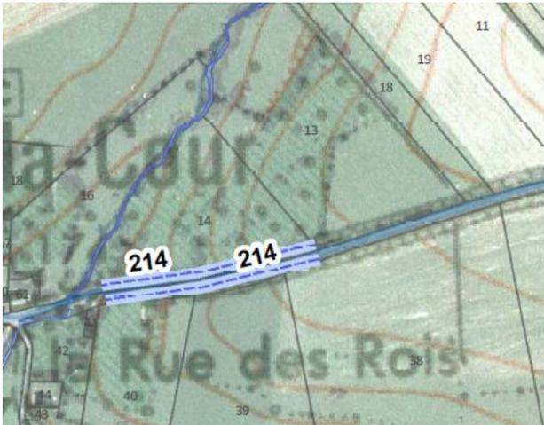
L’emplacement du profilé renforcé a été défini. En aval et en amont du profilé, un léger dérasement sera fait. Le profilé sera l’aménagement de l’accotement pour mieux gérer les écoulements de la route. Le renforcement de la route sera fait avec de la GNT 0/40 et le profilé sera consolidé avec de l’enrochement 80/150 en V avec une végétalisation à terme.
