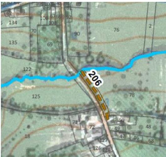
Le fossé à redents 206 sera mis en place après dépose de la canalisation actuellement implantée. Il sera important de créer un léger merlon en bordure de la pâture pour éviter de modifier l’axe d’écoulements en cas de fortes pluies.
