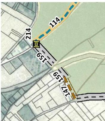
Le dépierreur n°214 est déplacé au point bas de la voirie en béton n°159 pour éviter d'avoir une sortie de canalisation dans l'axe de la voirie en béton.
