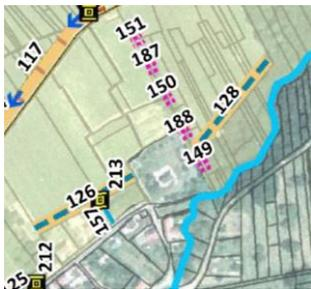
Est acté une modification des revêtements pour les chemins N°115, 114, 170, 126 et 128 par emploi d’une GNT 0/31,5 en lieu et place d’enrobés et une modification de la forme en V en dévers unique vers les coteaux amont.
