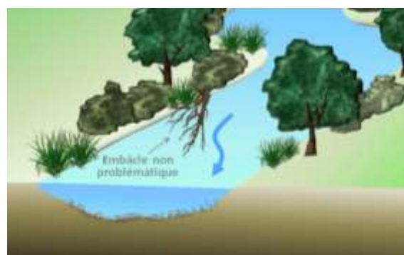
Les schémas ci-contre permettent de comprendre la différence entre un embâcle problématique et non-problématique
