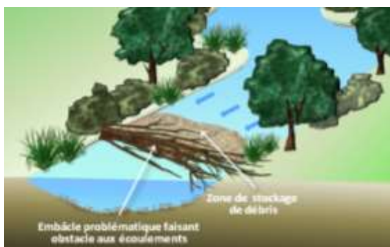
Les schémas ci-contre permettent de comprendre la différence entre un embâcle problématique et non-problématique
