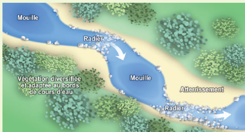
Cours d'eau sinueux et naturel (après travaux)
