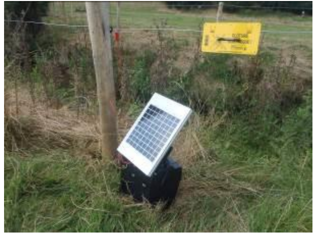
Electrificateur avec panneau solaire
